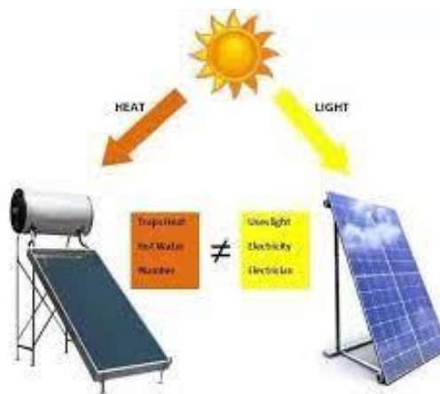
Fig. 2. Panouri solare termice (convertesc energia solară în căldură)
