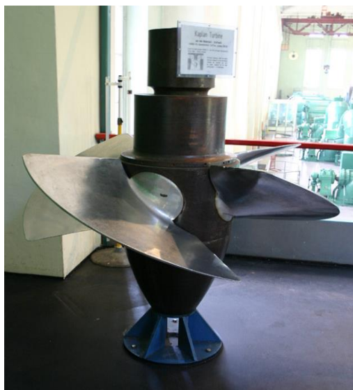
Fig. 1. Turbina Kaplan sau KVB
